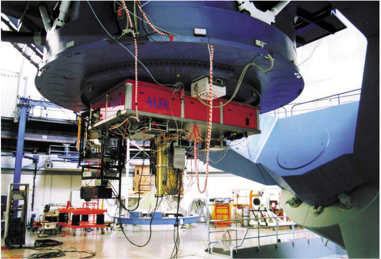
Abb. I.3: ALFA am Cassegrain-Flansch des 3.5-Meter-Teleskops, zusammen mit der golden schimmernden Kamera OMEGA.
