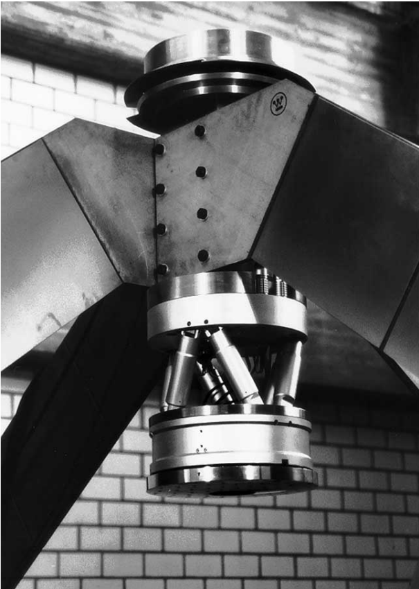
Abb. I.4: Die neue Sekundärspiegeleinheit des UKIRT mit einem Spiegeldummy in der Werkstatt des MPIA.
